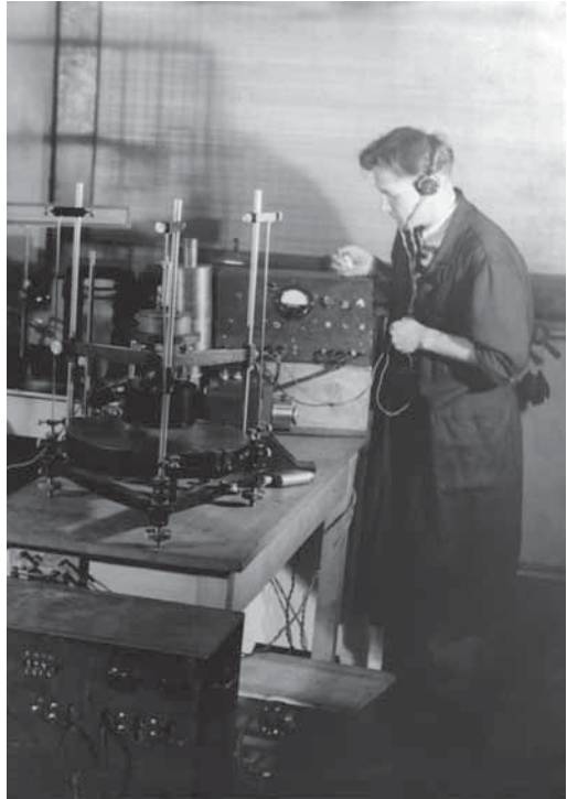
Stanowisko do pomiaru fotoemisji w temperaturze pokojowej (przełom lat 40. i 50. XX wieku) – z archiwum prywatnego B. Sujaka
